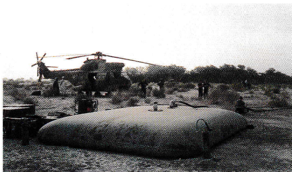
Réservoir souple pour approvisionnement des matériels et du personnel
